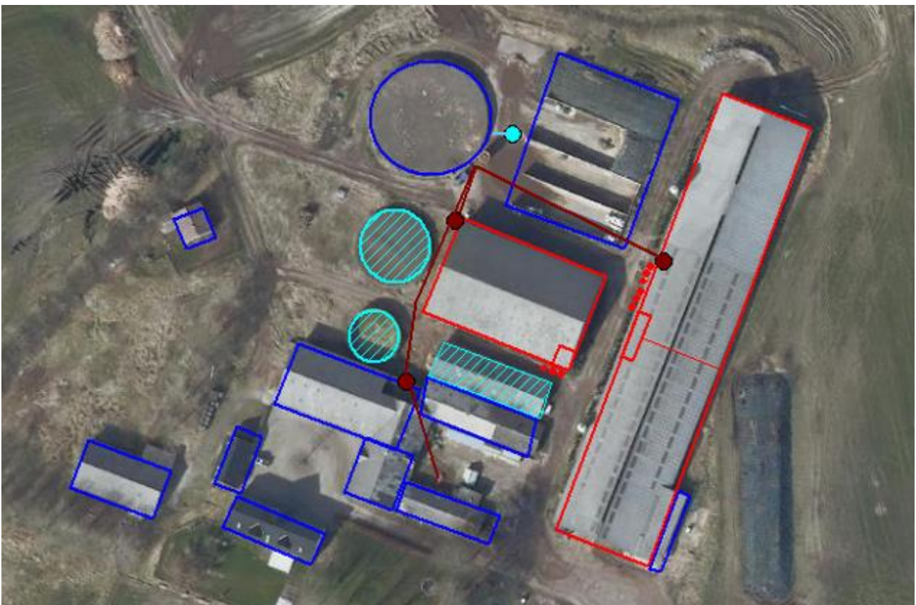
Figur 3. Oversigt over afløbsforhold på Hovmosevej 23. Det røde område er bygninger med dyrehold. De turkisrøgede bygninger fjernes i forbindelse med projektet. Den eksisterende samlebrønd er angivet med turkis prik, mens det eksisterende gyllesystem er angivet med brun optrukket streg.
